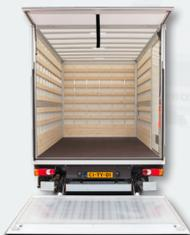
Parois latéral externe en polyester d'une épaisseur de 1.4 mm ou 4 mm avec une peau polyester spécial renforcer. L'intérieure est équipé de profils en aluminium ainsi que d'un lattis en bois. Le bas de la parois est fourni avec une plinthe de protections conçu avec 4 planche en bois l'un au-dessus de l'autre.
