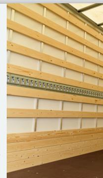
Un faux châssis en aluminium adapté au châssis du véhicule avec des longerons, traverses et un plancher 15 mm de bois Scandinave avec une couche antidérapante coller avec une colle imperméable. Le tout avec une finition imperméable.
