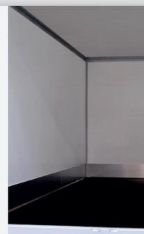
Un faux châssis en aluminium adapté au châssis du véhicule avec des longerons, traverses. Et un plancher 15 mm de bois Scandinave avec une couche antidérapante collée avec une colle imperméable. Le tout avec une finition imperméable.
