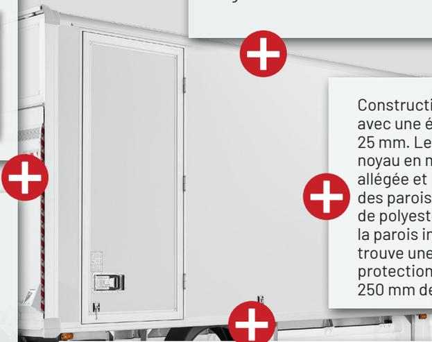
Construction Sandwich avec une épaisseur de 25 mm. Les parois ont un noyau en mousse PUR allégée et les deux côtes des parois ont une couche de polyester. Sur le bas de la paroi interne se trouve une plinthe de protection en aluminium de 250 mm de haut.
