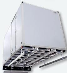
Construction Sandwich avec une épaisseur de 25 mm. Les parois ont un noyau en mousse PET recyclé et les deux côtes des parois ont une couche de polyester. Sur le bas de la parois interne se trouve une plinthe en composite de 250 mm de haut.
